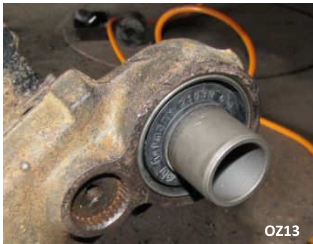
Bild 20 – die neue Buchse in der korrekten Endposition
